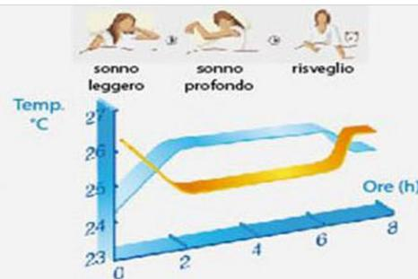
Modalità "COMFORT": regola automaticamente la temperatura interna in modo da garantire il massimo comfort durante il riposo notturno
