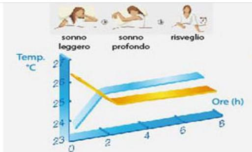
Modalità "SOUND": regola la temperatura interna automatica in modo da garantire la massima silenziosità durante il riposo notturno
